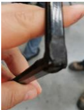
Angolo saldato con ricopertura di butile
