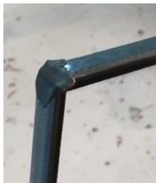
Angolo piegato con ricopertura di butile
